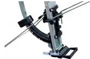
Detail der montierten Abrollvorrichtung
