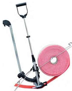
Tackergerät R2 mit montierter Abrollvorrichtung
