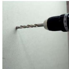
Ø 10 mm Loch in Rückseite bohren
